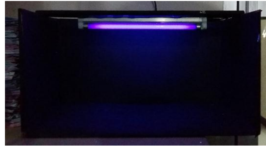
Gambar 5. Kotak hitam dengan lampu UV yang digunakan untuk penelitian.
